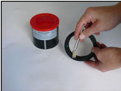
**Para no pinzar la junta, hay que lubricar ligeramente el exterior de ésta y el interior de los dos segmentos del acoplamiento, así como el interior de los labios de sellado y el exterior de los extremos de la tuberías.**
