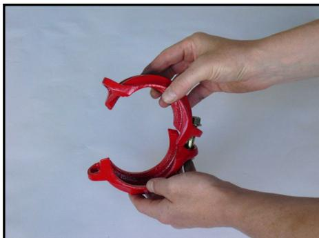
Se deben retirar los pernos y las tuercas de un lado del acoplamiento, si no se ha hecho ya, y aflojar los del otro lado, hasta que la rosca del perno no sobresalga de la tuerca.
