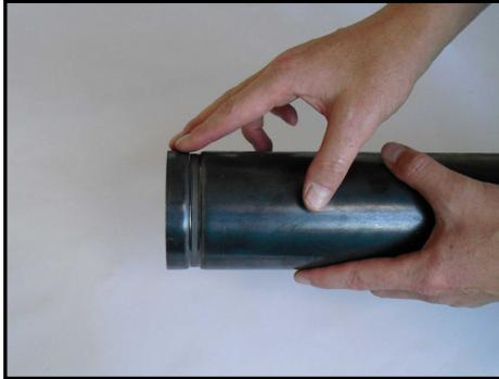
Los extremos de las tuberías no deben tener rebabas para evitar que se dañe la junta durante el montaje.
