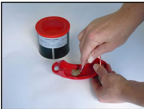
Cubra el interior de los dos segmentos del acoplamiento con una fina capa de lubricante.
